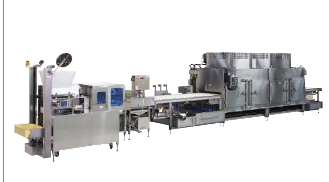
ライスプレート製造ライン
