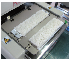
海苔巻きロボットで押し寿司シャリシートをダブル成形。
