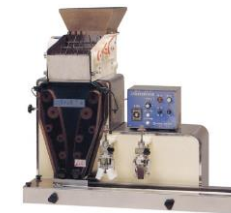
寿司ロボット1号機 江戸前寿司自動握り機 (1981年)
