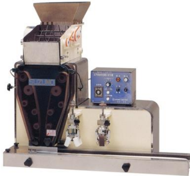
寿司ロボット1号機 江戸前寿司自動握り機
